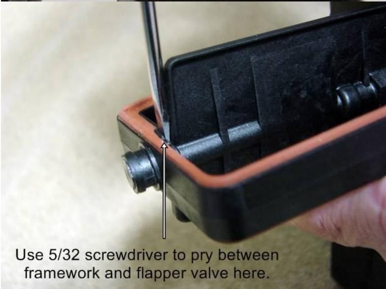
Удалите верхний направляющий штифт. Он сидит достаточно глубоко на одном уровне с рамой. Для его снятия можно вставить отвертку между лопастью и рамой слегка приподняв раму (следите за тем чтобы не повредить раму, чрезмерные усилия не допустимы). После снятия нагрузки штифт приподнимется над поверхностью рамы и его можно будет удалить.
