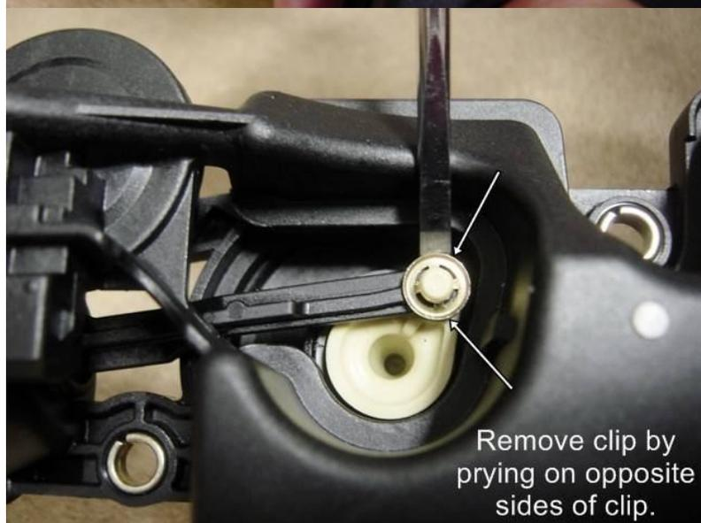
Снимите фиксирующую шайбу, поддев её отверткой, чередуйте поддевания с разных сторон, с тем **чтобы сохранить шайбу в целостности.**
